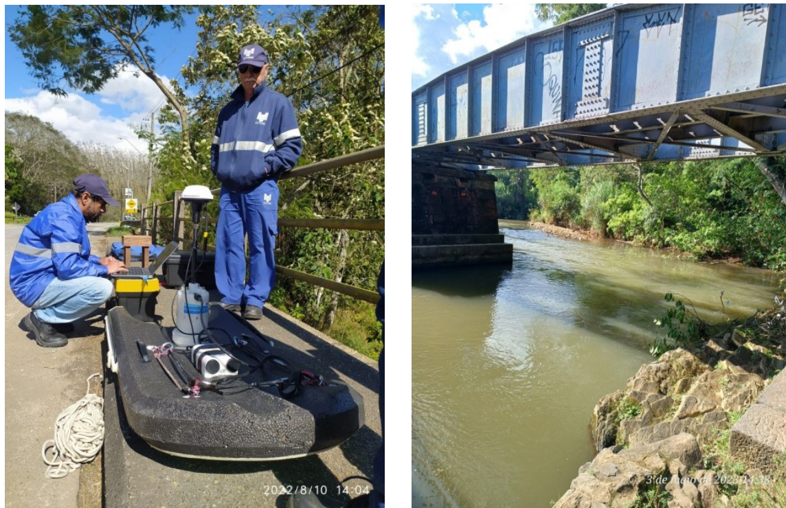
Figura 3.4 – Exemplo de medição de vazão realizada pela CETESB a jusante do ponto integrado da rede CETESB/ANA, UAMA 00600 no Rio Piracuama, em Pindamonhangaba
