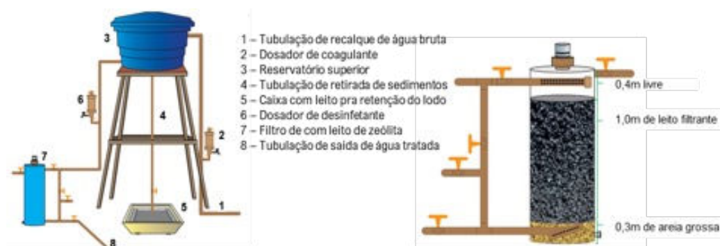
Figura 1 - Ilustração da SALTA-z em escala real e detalhamento do filtro
