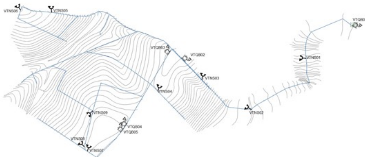
Figura 13 - Localização das ventosas na rede de fertirrigação.
