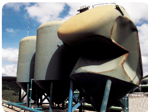
Filtro do sistema deformado por pressão atmosférica
