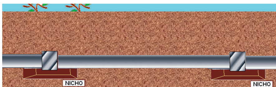
Nichos de fundo de vala
