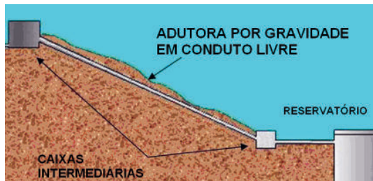
Adutora por gravidade em conduto livre
