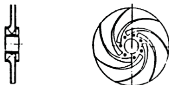
Rotor aberto sem paredes, contando apenas com
