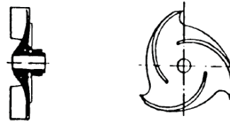
Rotor fechado com 2 ou 3 pás
