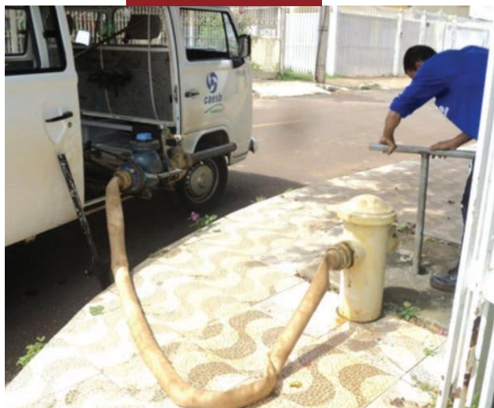
Figura 6 – Veículo equipado com hidrômetro para medição de descarga
