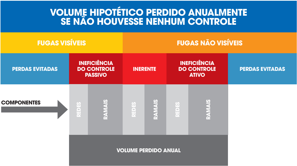
Figura 2 – Esquema conceitual para obtenção de componentes das perdas reais anuais na metodologia BABE
